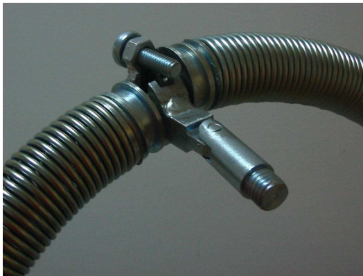
Рис. 19. Подготовленный к проведению контроля пружинный электрод
