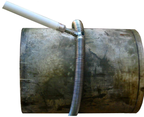
Рис. 21. Подготовленный к проведению контроля пружинный электрод с подсоединенными захватом и удлинителем
