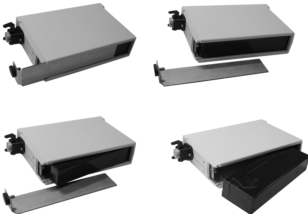
Рис. 24. Последовательность действий при замене аккумулятора
