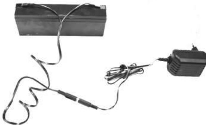
Рис. 23. Внешний заряд аккумулятора: подсоединение к переходному разъему на кабеле зарядного устройства соединительного кабеля с клеммами для подключения к аккумулятору и подсоединение клемм кабеля зарядного устройства к выводам аккумулятора
