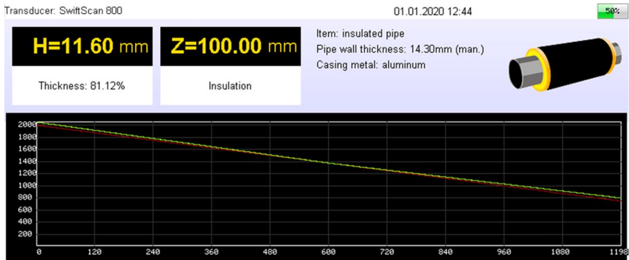
Рисунок 29. Пример внешнего вида А-скана
