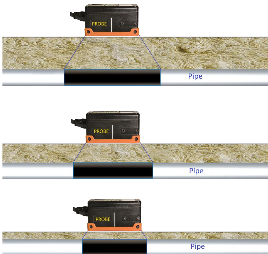
Рисунок 28. Зависимость размера области намагничивания от толщины изоляции
