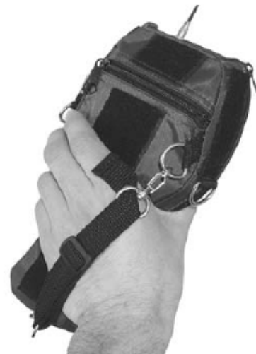
Рисунок 10 - Захват дефектоскопа рукой
