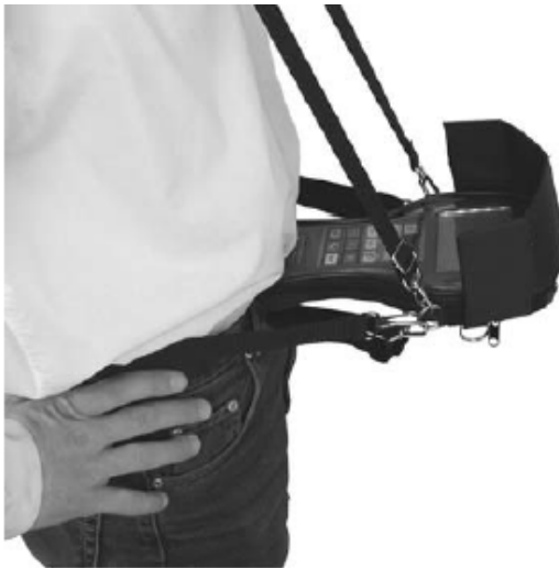
Рисунок 9 - Крепление дефектоскопа на поясе
