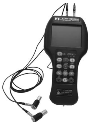
Рис. 4.3 Подключение преобразователей Т1802
