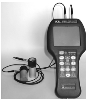
Рис. 4.1 Подключение преобразователей S0206 в раздельном режиме.
