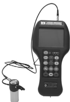
Рис. 4.2 Подключение преобразователя S0205 в совмещенном режиме
