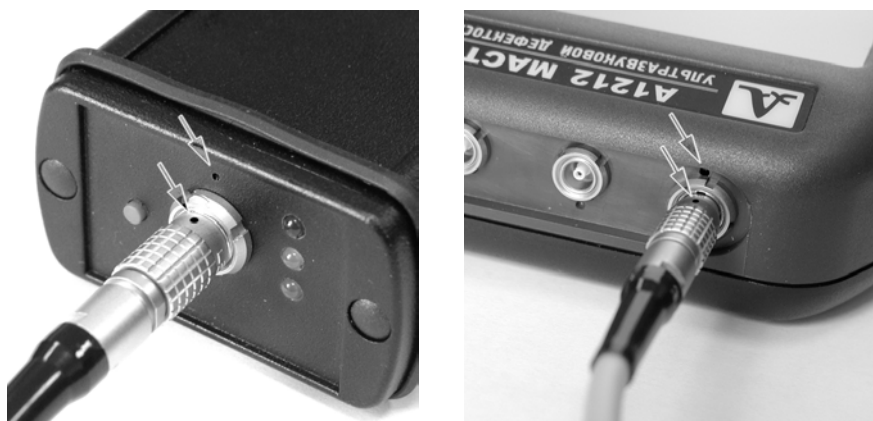
Рис. 5.1 Ориентация разъемов при подключении зарядно-питающего устройства
