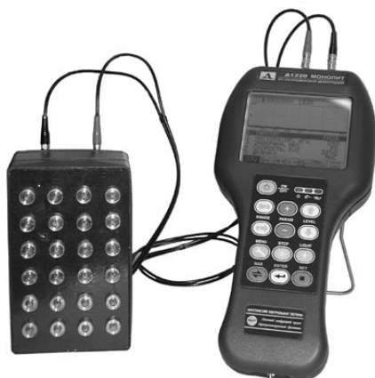
Рис. 4.4 Подключение АР М2002, М2502.
