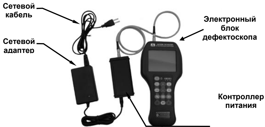
Рис. 5.2 Соединение электронного блока прибора с блоками ЗПУ.
