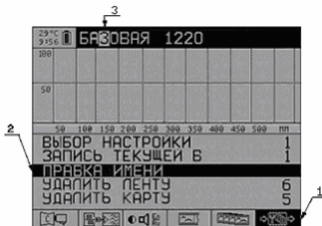
Рис. 4.5 Экран в режиме МЕНЮ. Редактирование названия конфигурации (1 – активный раздел; 2 – активный пункт; 3 – редактируемая буква).
