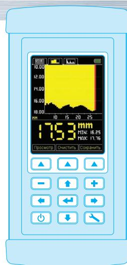
Применяется для поиска коррозионных повреждений при проведении сканирования объекта контроля с отображением графического В-Скана.
