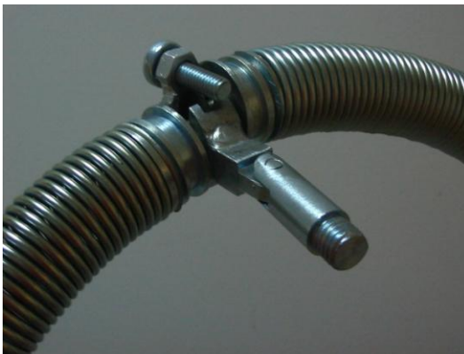
Рис. 19. Подготовленный к проведению контроля пружинный электрод
