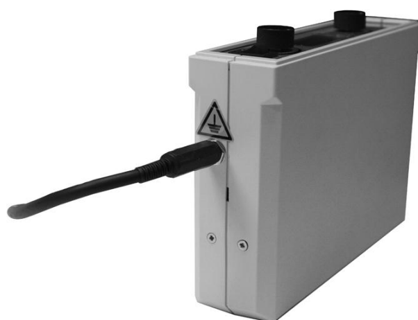
Рис. 6. Разъем « \oplus » для подсоединения провода заземления (изображен прибор с подсоединенным проводом заземления)
