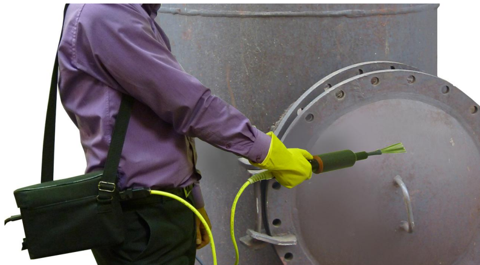
Рис. 18. Положение прибора при проведении контроля
