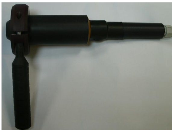
Рис. 20а. Высоковольтный трансформатор-держатель с надетой съемной ручкой.
