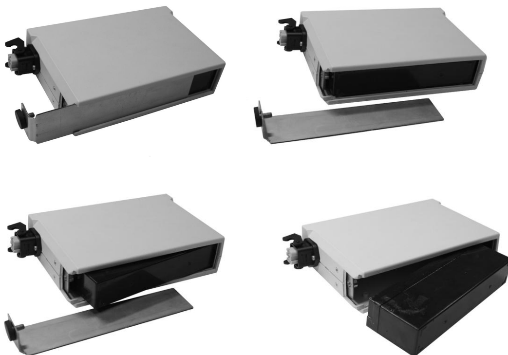
Рис. 24. Последовательность действий при замене аккумулятора
