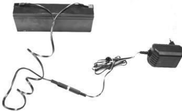
Рис. 23. Внешний заряд аккумулятора: подключение к переходному разъему на кабеле зарядного устройства соединительного кабеля с клеммами для подключения к аккумулятору и подсоединение клемм кабеля зарядного устройства к выводам аккумулятора
