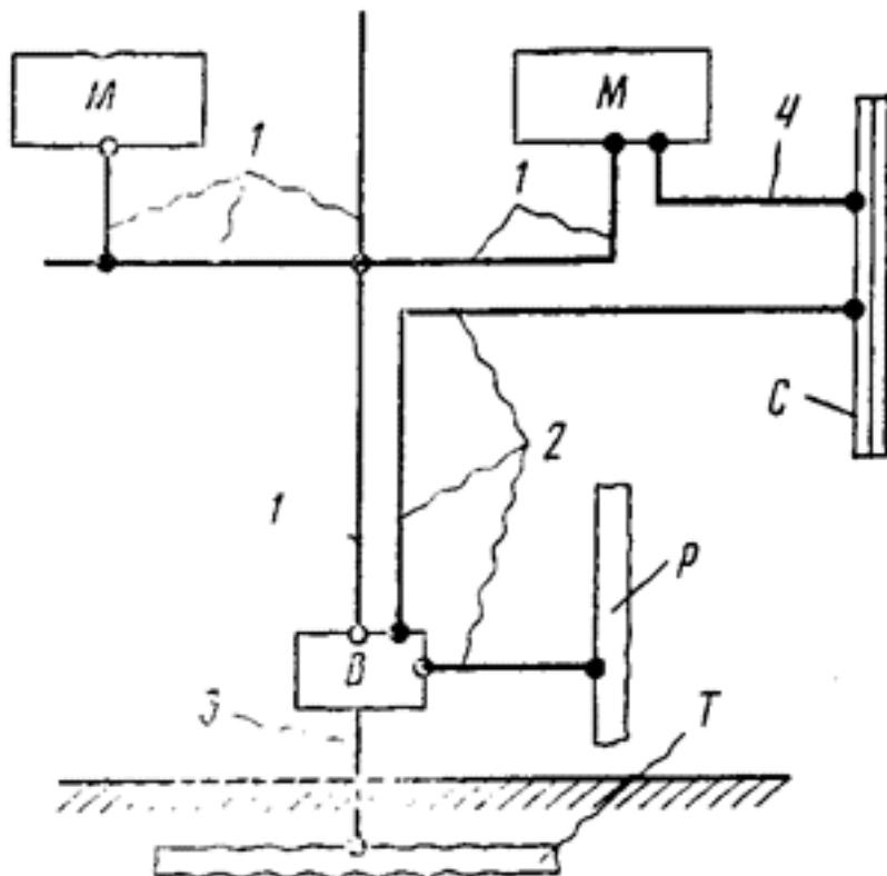
1 — защитный проводник; 2 — главный проводник системы уравнивания потенциалов; 3 — заземляющий проводник; 4 — дополнительный проводник системы уравнивания потенциалов; В — главный зажим (болт) заземления; М — заземляемая часть электрооборудования (открытая проводящая часть); С — металлоконструкция здания (сторонняя проводящая часть); Р — металлический стояк (труба) водопровода; Т — заземлитель
