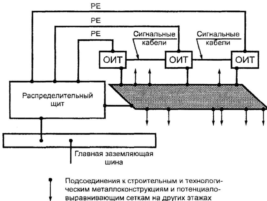
Рисунок В.3 — Система горизонтального и вертикального эквипотенциального заземления
