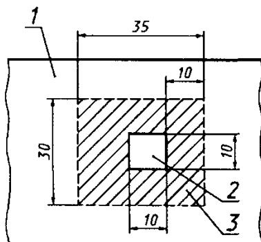
1 - испытуемое покрытие; 2 - образец покрытия сдвига;
