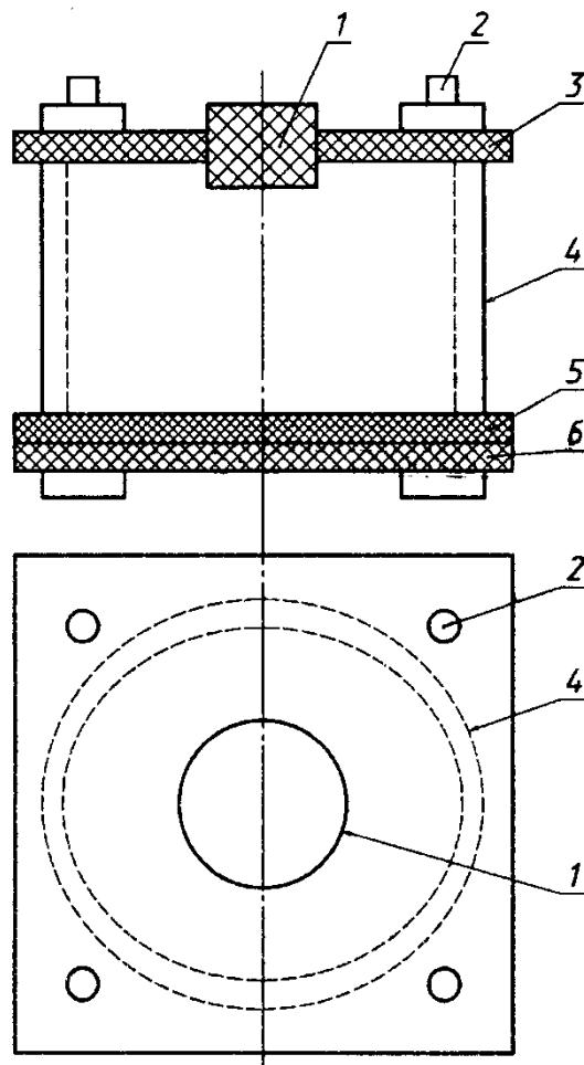
1 - пробки резиновые; 2 - крепежные шпильки с гайками; 3 и 6 - крышки из стеклотекстолита;
