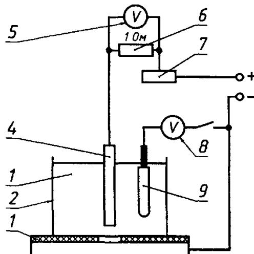
1 - пластина (карта) - испытуемый образец; 2 - труба из полиэтилена; 3 - электролит;
