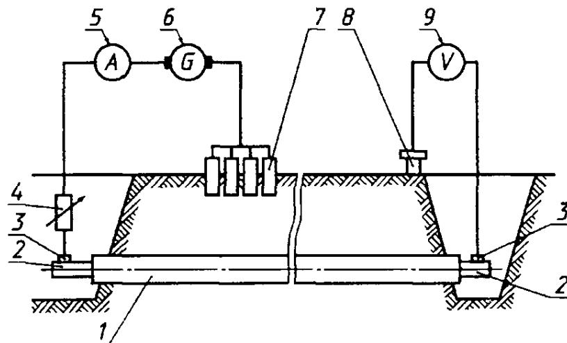
1 - трубопровод; 2 - неизолированный конец трубопровода; 3 - контакты; 4 - резистор;
