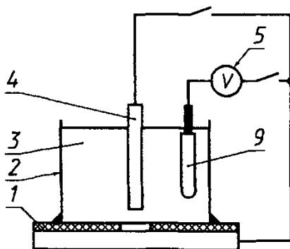
1 - пластина (карта) - испытуемый образец; 2 - труба из полиэтилена;
