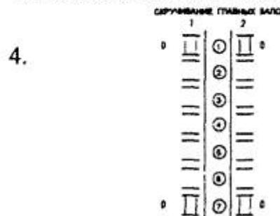
+ означает скручивание низа балки в сторону уширения колей
