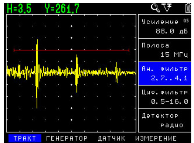
б) Сигналы после включения аналогового фильтра 2,7-4,1 МГц.
