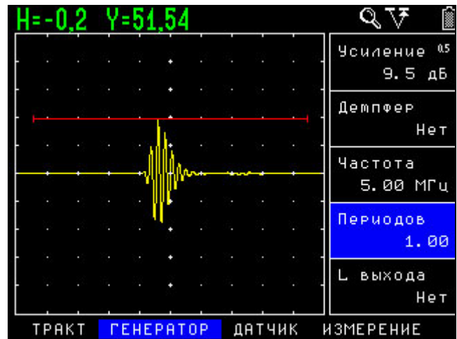
а) Стандартный преобразователь 5МГц. Возбуждение 1 периодом частоты
