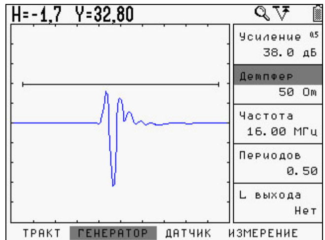
б) С демпфированием генератора 50 Ом
