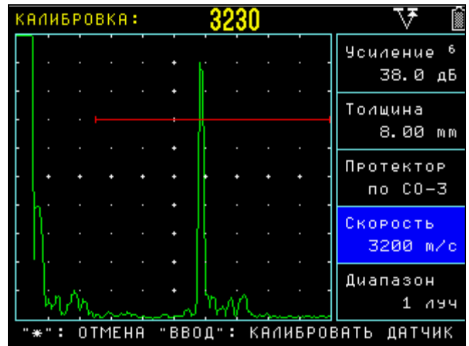
рис.3-9 Калибровка скорости в образце
