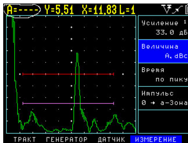
Рис.4-3 Отображение запрета на измерение амплитуды A,dbc при включенной ВРЧ
