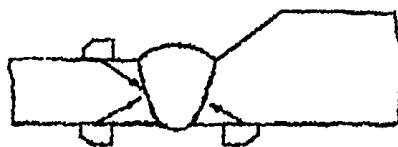
Рис.17. Пример контроля сварных соединений элементов, имеющих скосы от кромок
