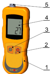
Рис.5 Основные части прибора ТК-5.04С, органы управления
