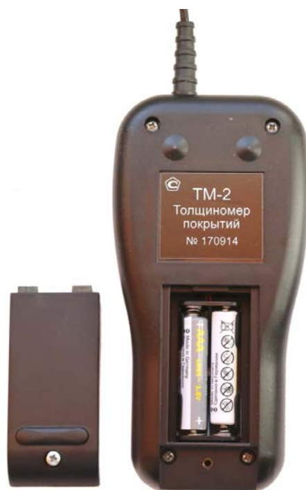
Рис 1-1 Вид прибора со снятой крышкой батарейного отсека
