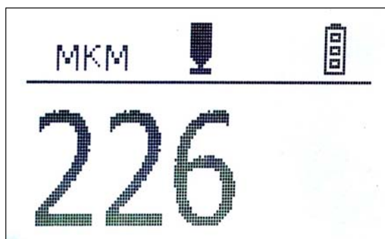
Рис. 2-2 Результат калибровки на образце 226 мкм
