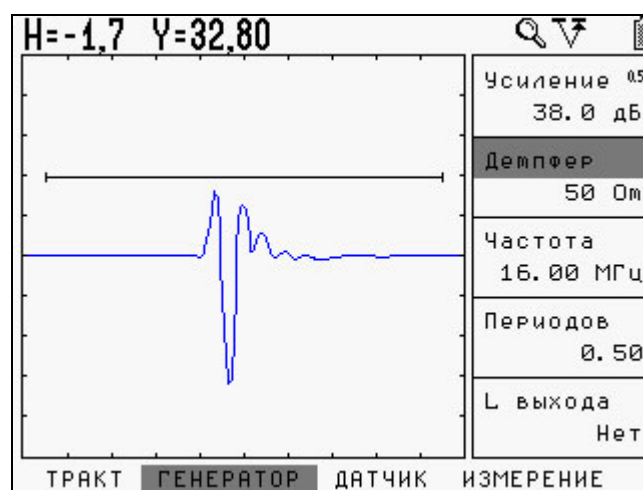
б) С демпфированием генератора 50 Ом
