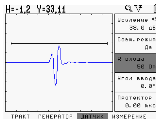
в) С включенными демпферами генератора и приемника (общий демпфер 25 Ом)
