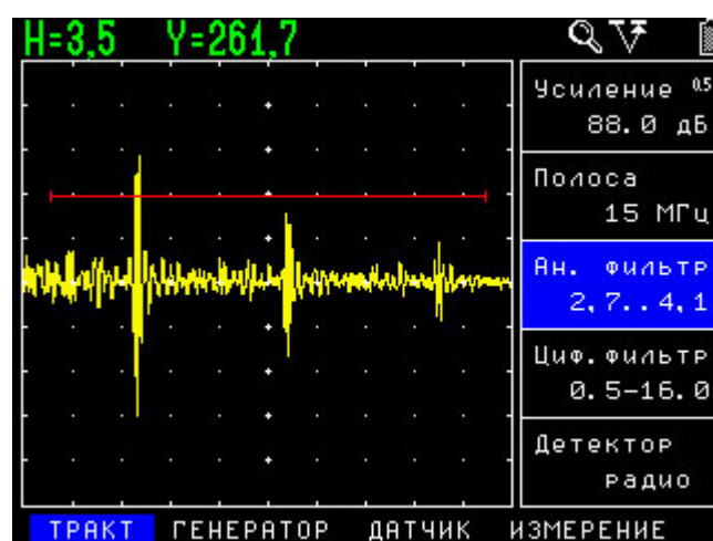
б) Сигналы после включения аналогового фильтра 2,7-4,1 МГц.
