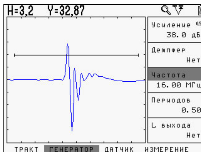
а) Широкополосный преобразователь 15МГц, подключенный без демпфирования
