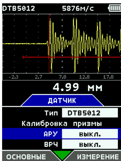
Рис. 6.-18 Измерение разных толщин без использования АРУ.
