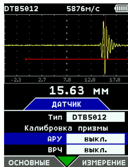
Рис. 6.-18 Измерение разных толщин без использования АРУ.
