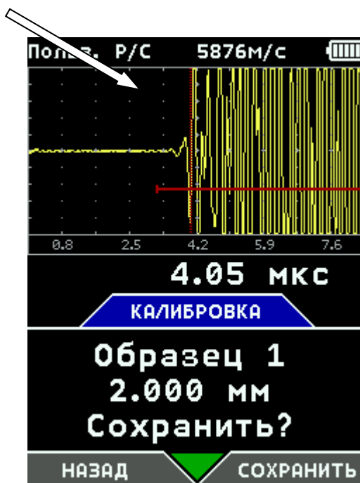
Рис.6-23 Калибровка первого образца
