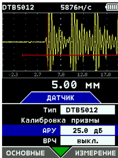
рис. 6-17 Измерение разных толщин с использованием АРУ
