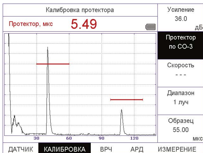
Рис. 3-13 Калибровка наклонного преобразователя по образцу СО-3
