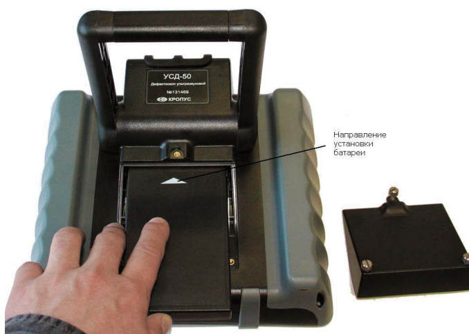
Рис. 1-4 Установка нового аккумулятора
