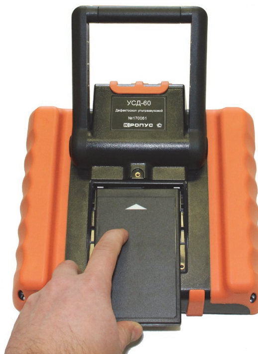
Рис. 1-4 Установка нового аккумулятора
